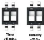
Ventilatorul se va porni automat atunci când senzorul de umiditate incorporat detectează o umiditate de peste 70 % (SECȚIUNEA 1) și va funcționa până când senzorul de umiditate detectează o scădere la 70 % sau mai puțin (SECȚIUNEA 1). Ventilatorul va funcționa apoi timp de 15 minute (consultați SECȚIUNEA 2) și se va opri.
