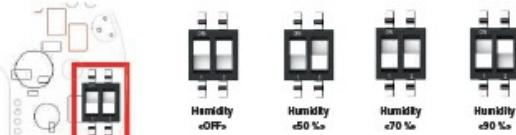
Ha a páratartalom-érzékelő ki van kapcsolva, a ventilátor nem működik automatikusan. A ventilátor bekapsol, amikor áramot kap, és addig működik, amíg áram van rajta.
