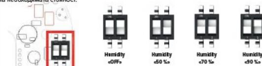
Ако сензорът за влажност е изключен, вентилаторът не работи автоматичен режим. Вентилаторът ще се включи при подаване на захранване, и ще работи, докато има захранване.
