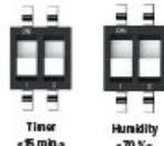
Ventilátor se automaticky zapne, když vestavěný senzor vlhkosti zjistí překročení 70 % (viz ODDÍL 1), a bude pracovat, dokud senzor vlhkosti nezjistí pokles na 70 % nebo nižší (viz ODDÍL 1). Ventilátor pak počešť 15 minut (viz ODDÍL 2) a vypne se.
