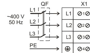
Schaltplan für die Ventilatoren FKO und FKO/400V
